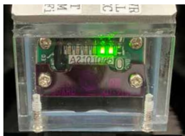
LED2個点灯 ＜主電源ONの状態＞
