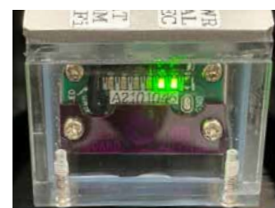
主電源をONにするとLED2個 点灯
